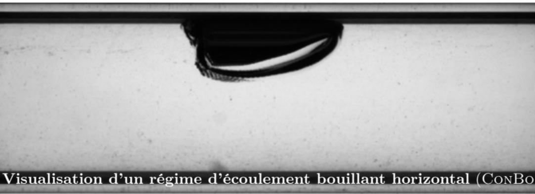
Visualisation d'un régime d'écoulement bouillant horizontal (ConBo)
